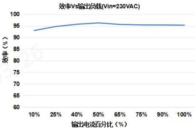
图5 效率 VS 负载曲线
