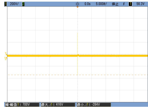
输出端电压波形(0.41KV)
